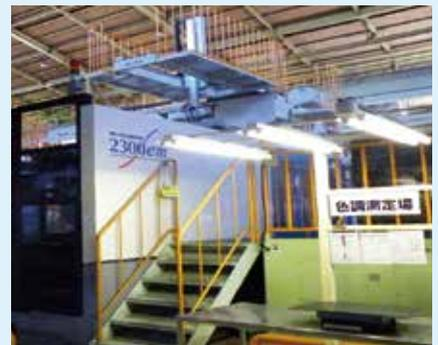
成形設備/射出成形機(電動機)
