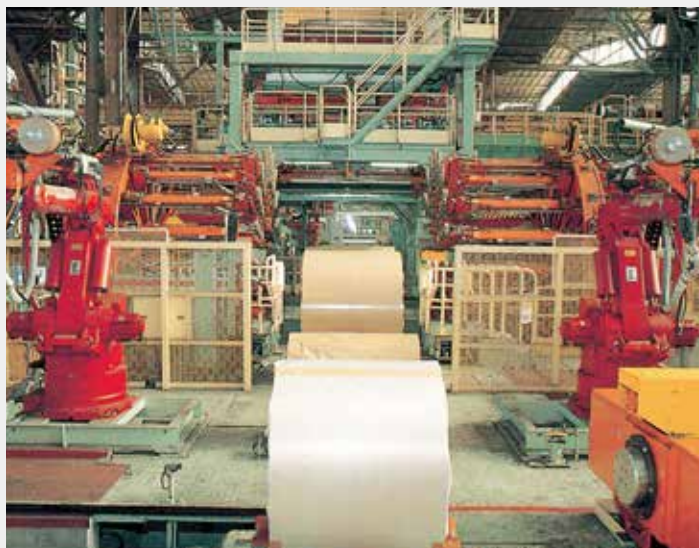
最新のFA技術と数々の斬新な発想を結集し、世界一の高自動化率と高生産性を可能にした自動コイル梱包ライン
