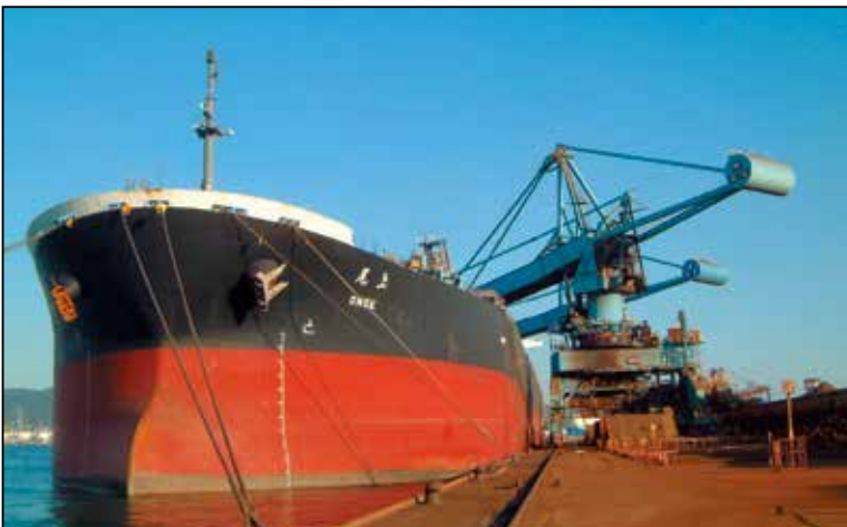
原料を荷揚げする連続式アンローダー
