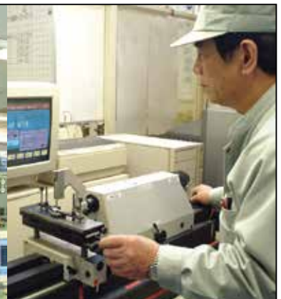
再研磨後のバイト角度測定
